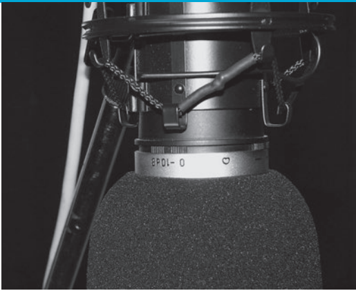
Pegelschalter (-10 dB), um laute Pegel etwas herunter zu dämpfen
