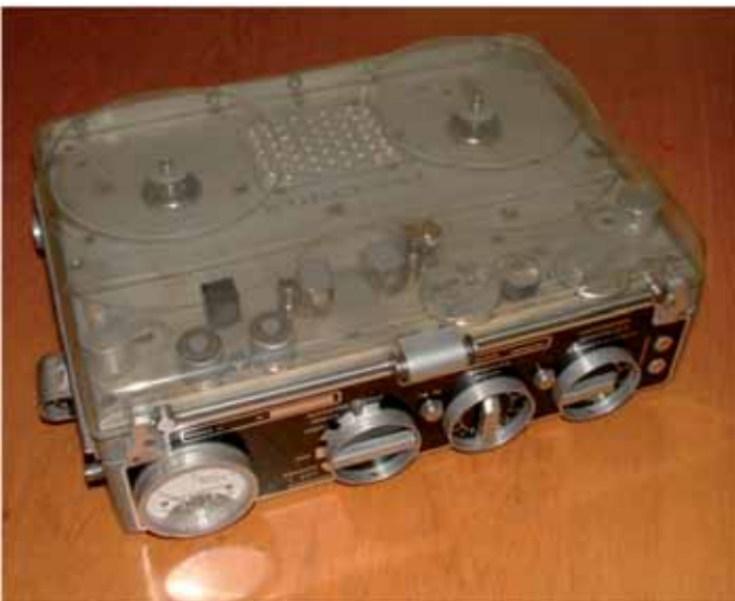
Bild 8. Walkman, für Jahrzehnte ein Standard im Rundfunkbereich, die NAGRA.
