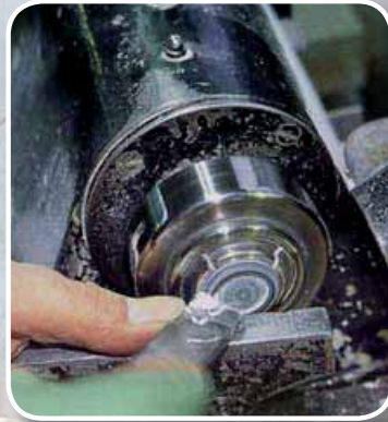
Bearbeitung des Rohlings bis zur endgültigen Knopfform
