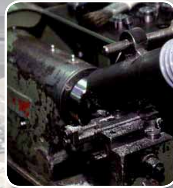
Bearbeitung des Rohlings bis zur endgültigen Knopfform
