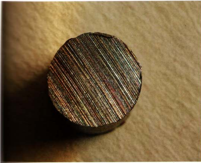
Bild 1. Unsachgemäß entnommener Schliff mit Wärmeeinwirkungszonen, 1:1
