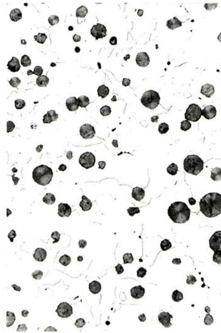
Bild 1.2: Gußeisen mit Kugelgraphit, 100:1
