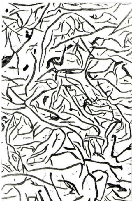
Bild 1.1: Gußeisen mit Lamellengraphit, 100:1
