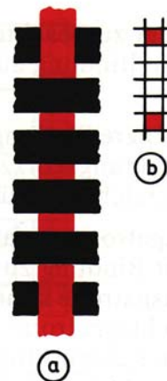
Abb. 5a: Kettflottierung unter 4 Schüssen (auf der linken Gewebeseite) und ihre Patronierung (b)
