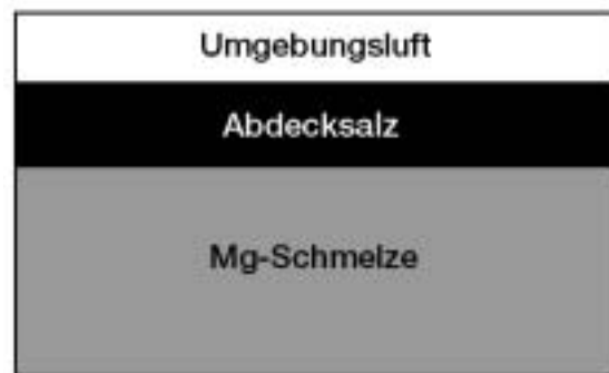
Schmelzflüssiger Salzfilm auf der Mg-Badoberfläche (schematisch)
