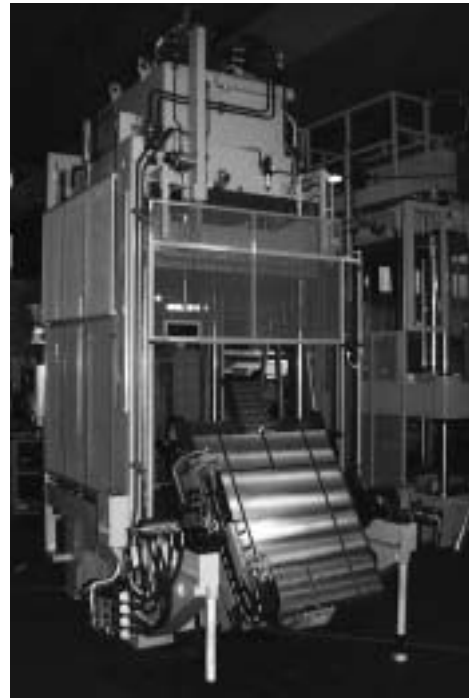
Bild 1. Hydraulische Abgratpresse KZP 120 (Tecnopres S.r.l. Chieri, Italien)
