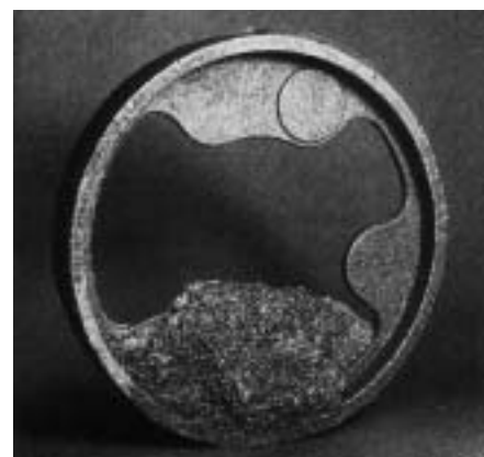
Bild 2. Abgefallenes Sandstück im Oberkasten vor dem Zulegen der Form
