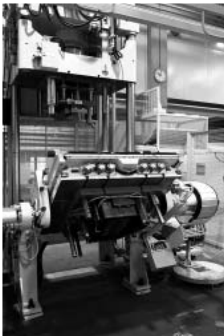
Bild 3. Entgratpresse von Reis der Baureihe SEP (Reis Robotics, Reis GmbH & Co. Maschinenfabrik, Obernburg)
