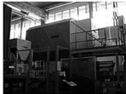
Bild 1. Einteilige Absaughaube über einer Bühler E140D (KMA-Kurtsiefer Maschinen- und Apparatebau GmbH, Königswinter-Oberpleis).
