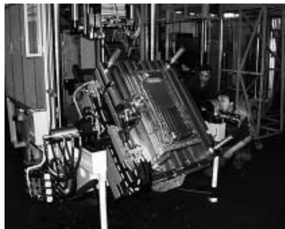
Bild 2. Entgratwerkzeug von Tecnopres (Tecnopres S.r.l. Chieri, Italien)
