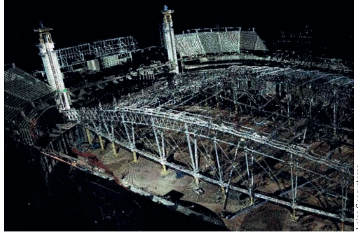
TRADITIONELLE MESSMETHODEN messen nur markante Objektpunkte auf, das Laserscanning hingegen Millionen von Punkten.
